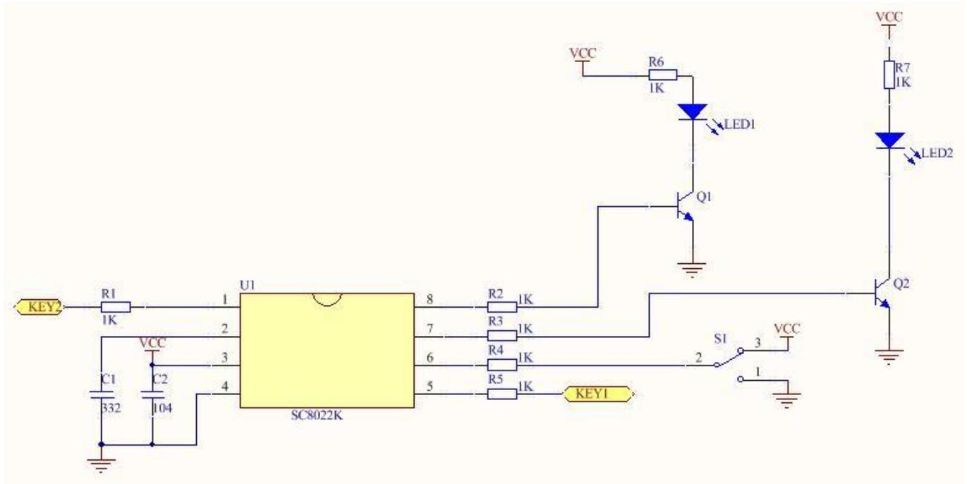
注：当介质材料及厚度等差异较大时，可通过调整 C2 采样电容容值来调节触摸灵敏度。电容容值越大，灵敏度越高；电容容值越小，灵敏度越低。
