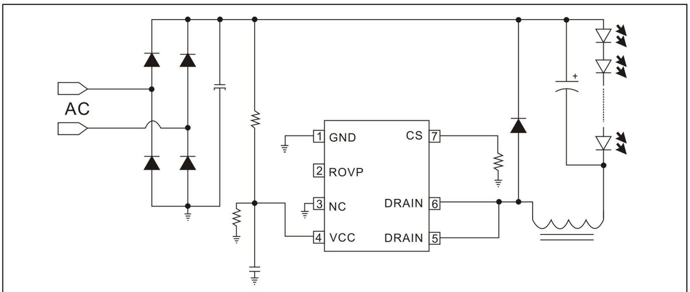
备注：Rovp PIN 接地，则内置过压保护，Tovp 约 6Us；Rovp PIN 悬空，则没有过压保护功能。
