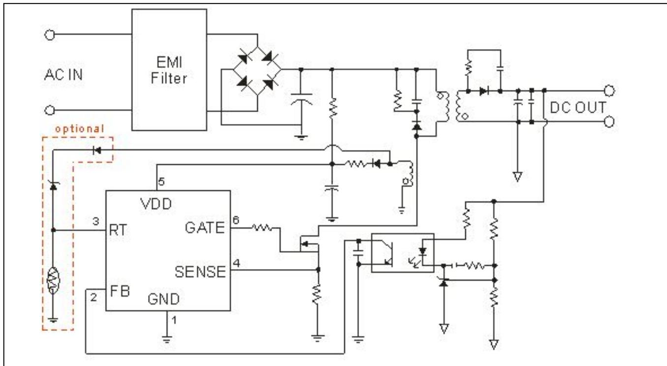
备注：虚线框中的 diode、zener 和 NTC 电阻为可选元件，用于外部可编程的 OTP 和 OVP。
